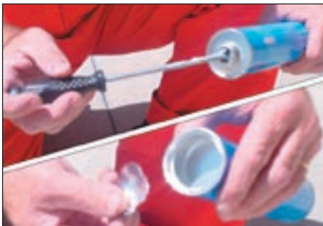
1. Perforar la tapa del extremo del cartucho y quitar la tapa metálica de la base.
