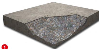
**1** Cortar perpendicularmente el área a reparar y sañar el hormigón hasta alcanzar un soporte sólido.
